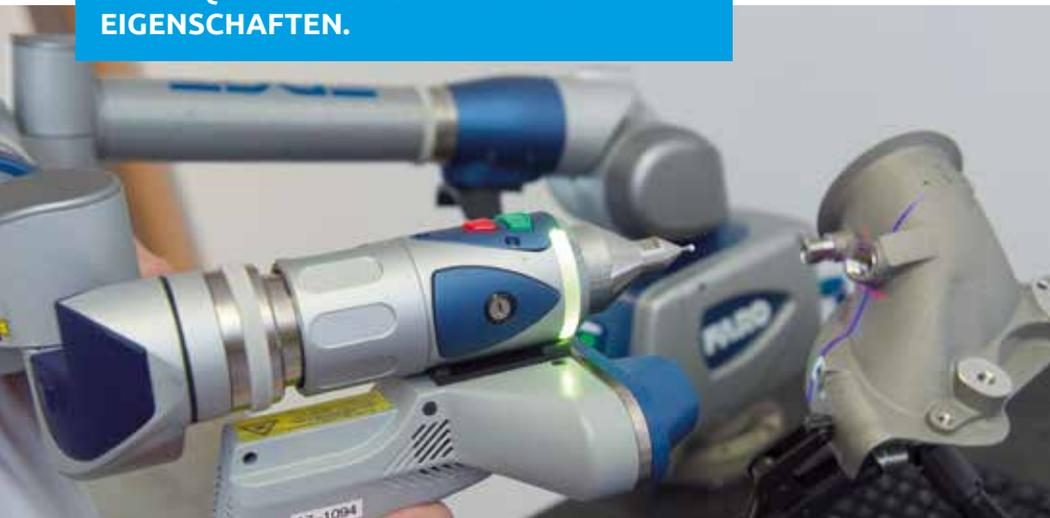
Bei Feinguss besteht ein enger Zusammenhang zwischen Wirtschaftlichkeit und Toleranzen. Diese sollten darum nie enger gewählt werden, als es erforderlich ist. Die erzielbaren Genauigkeiten sind durch die Art der Modell- und Formherstellung bedingt. Sie sind außerdem abhängig von der Form und Größe des Gussstückes und von der durch die Gestaltung des Teiles gegebenen freien oder gehemmten Schwindung.
